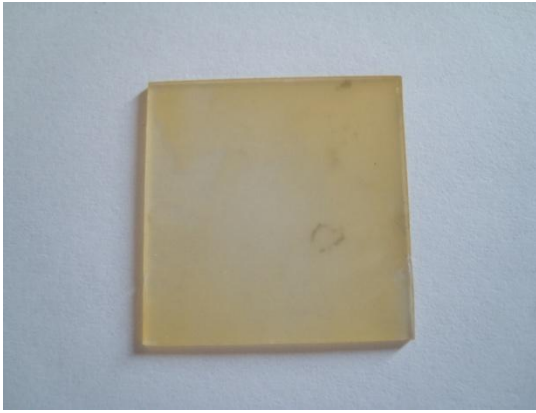
Figura 4.16 Películas de ZnO:Al con NA7 después de ser sometidas a un proceso de desorción
