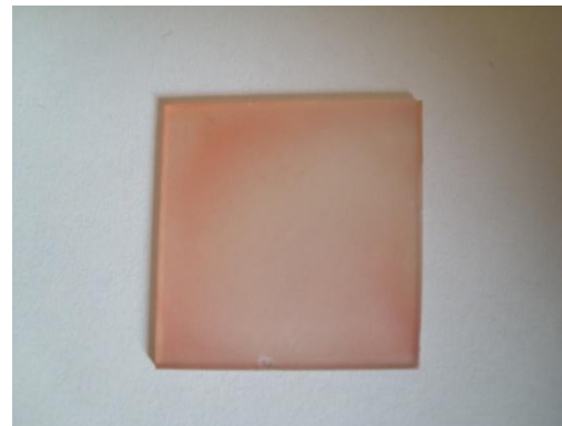
Figura 4.18 Películas de ZnO:Al con RA151 después de ser sometidas a un proceso de desorción
