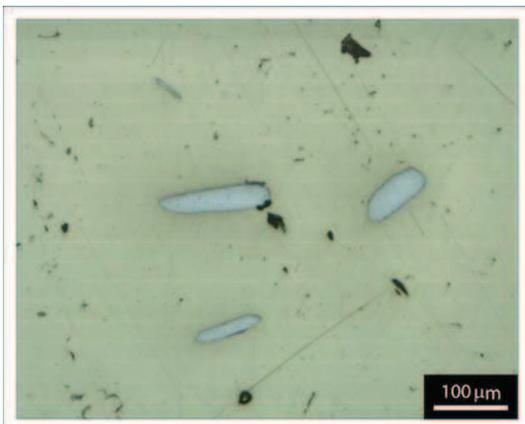
**Figura 5.** Cristales de una posible sulfosal de Pb, incluidos en calcopirita. Luz transmitida
