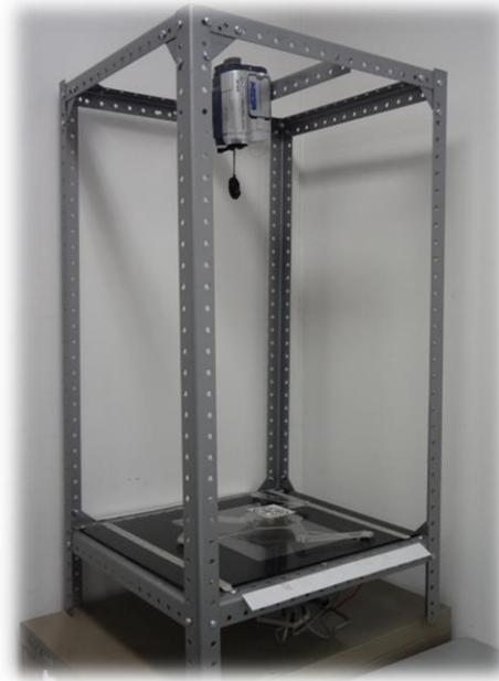
**Figura 3.2:** Estructura de perfil de estantería para montar la cámara y el modelo funcional.
