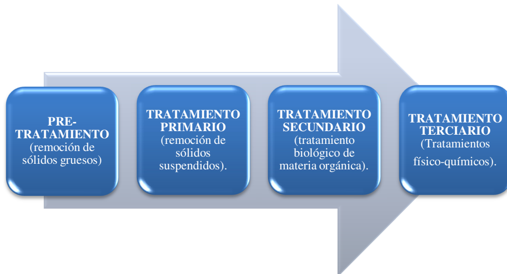
Figura 2.7. Proceso del Tratamiento de Aguas Residuales.
