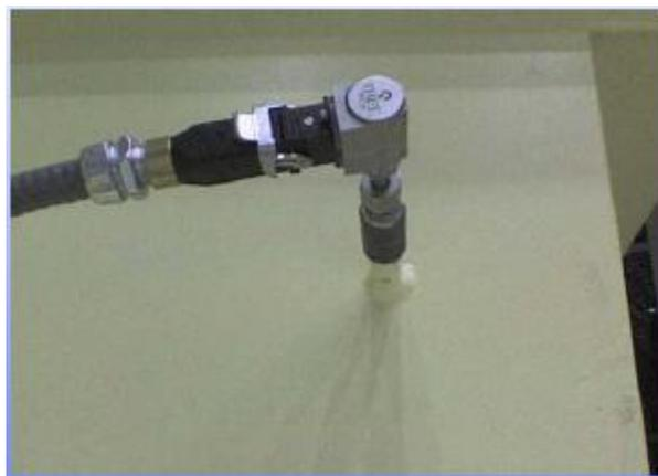
FIGURA 4-4 SENSOR DE HUMEDAD EN EL ACEITE
