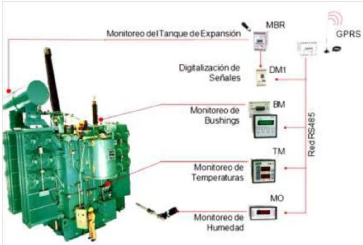
FIGURA 4-2 ARQUITECTURA DE SENSORES DEL SISTEMA DE MONITOREO
