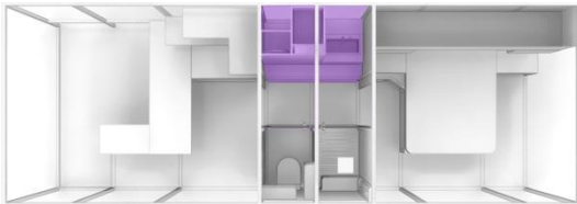
Fig. 2.16 –Planta superior del Habita-Mueble (Lavabo-Closet).
