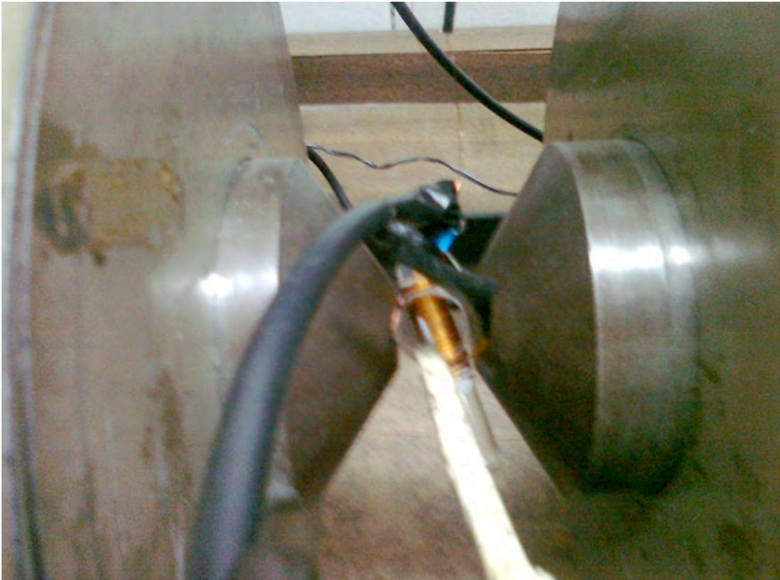
Figura E.4. Fotografía de la muestra y las antenas de emisión y recepción entre las placas del imán.
