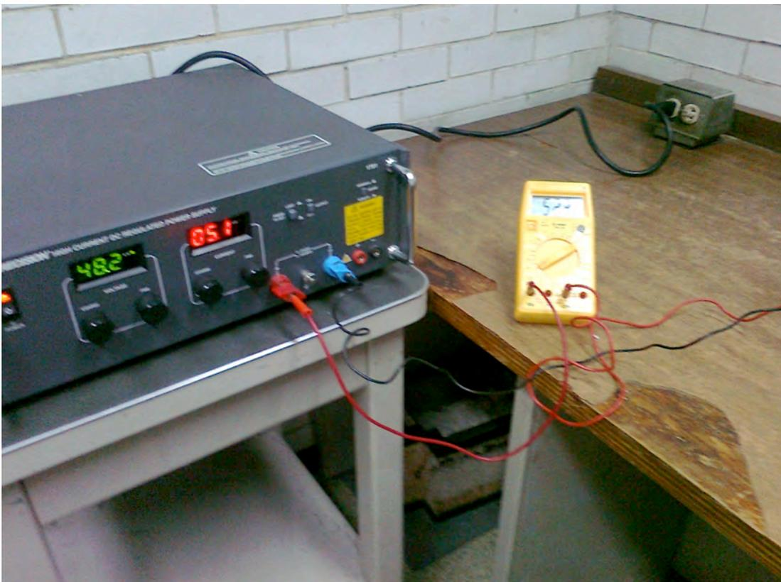
Figura E.1. Fotografía de la fuente de corriente directa *BK Precision* conectada al multímetro.
