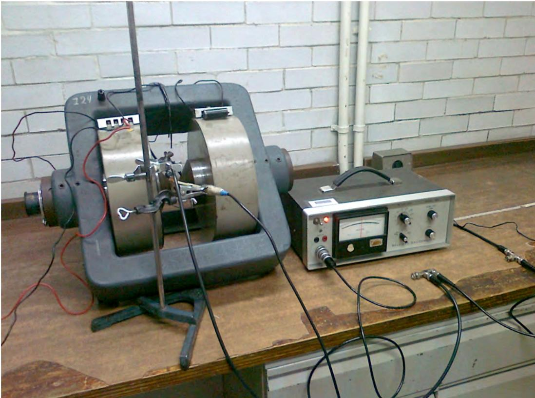
Figura E.2. Fotografía del imán *CENCO* con la Punta Hall y el gaussmetro *Bell*.
