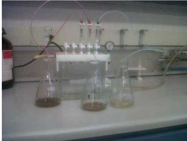
Figura A5. Muestras pasando a través de los cartuchos.
