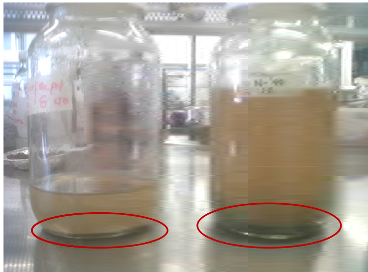
Figura VI.3. Mezcla resultante en el derrame y mezcla resultante en la descarga inferior.
