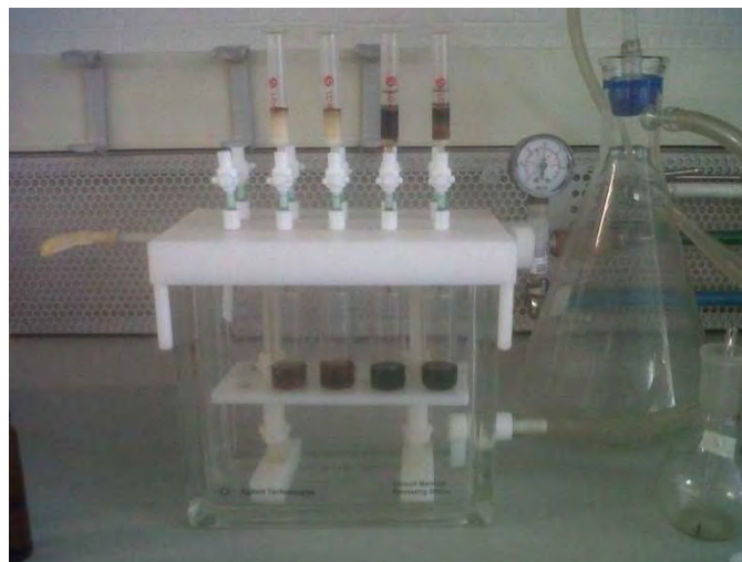
Figura A4. Cartuchos SUPELCO en el manifold para la filtración de muestras.
