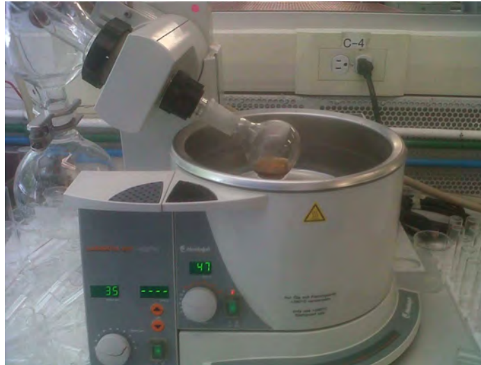
Figura A3. Muestra en el rotavapor para quitar el hexano.
