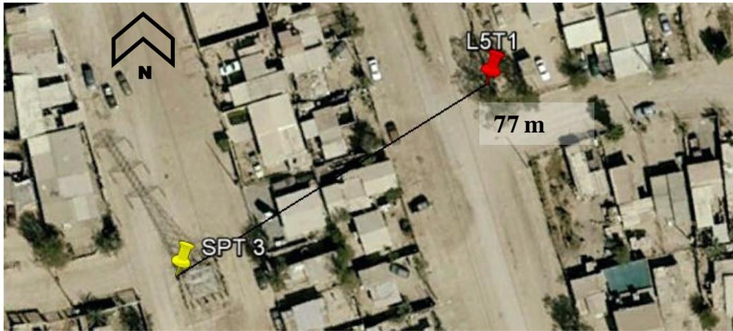
Figura 7.24. Distancia entre la prueba SPT 3 y el perfil sísmico L5T1
