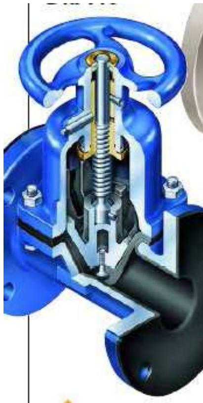
La válvula de retención esta destinada a impedir una inversión de la circulación. La circulación del líquido en el sentido deseado abre la válvula; al invertirse la circulación, se cierra.
