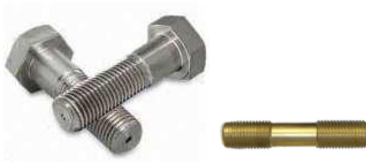
Los birlos han desplazado ampliamente a los tornillos para sujetar bridas debido a que son mas fáciles de remover si están corroídos. La confusión con otros tornillos en un equipo se evita, y si no se encuentra en almacén se puede cortar un esparrago ( tramo recto largo de tornillo ) o maquinado por un torno.
