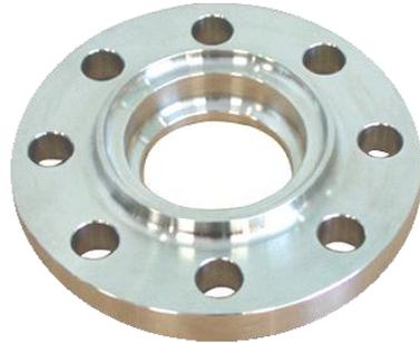
Brida roscada ( screwed flange ). Estándar o reductora, se usa para conectar sistemas roscados a un equipo bridado, usada principalmente a presiones medias y en diámetros no mayores a 38 mm Ø. Se debe sellar con un cordón de soldadura cuando la presión exceda a 500 psig ó la temperatura de 320°C.
