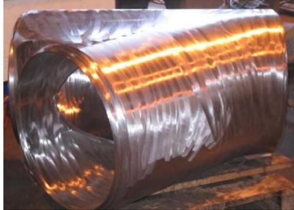
**Injerto angulado** En este tiempo de uso raro, puede ser obtenido de proveedores en ángulos de  $90^\circ$  y  $45^\circ$ ; se prefiere realizarlos en campo. Necesita revisarse en cada caso sus esfuerzos mecánicos. Si se desea otro ángulo o reducción, incluyendo excentricidades, solo se podrá conseguir con orden especial.
