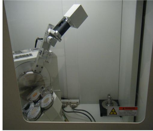
Lámina 4.6. Muestras dentro del difractómetro, para su análisis.
