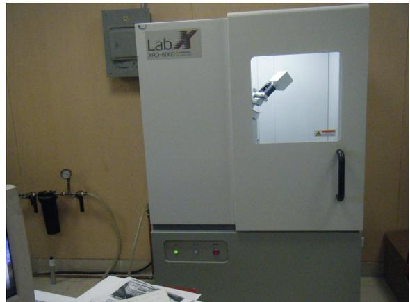
Lámina 4.8. Difractómetro Shimadzu XRD-6000, en el Laboratorio.
