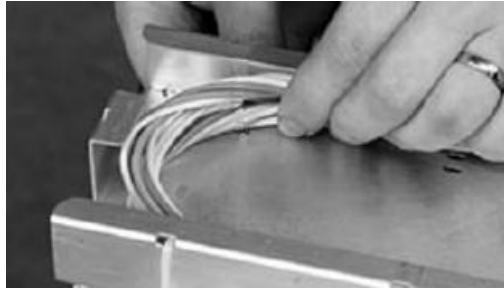
Figura 3.40. Enrollado de los tubos holgados en la canasta del cierre.
