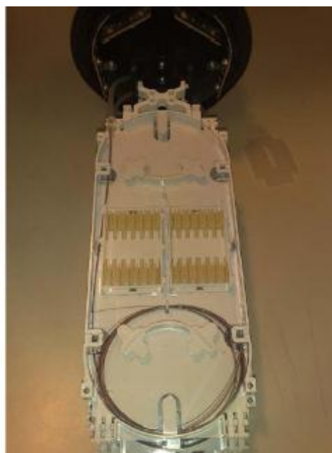
Figura 3.22. Colocación de los Splitter por código de color.
