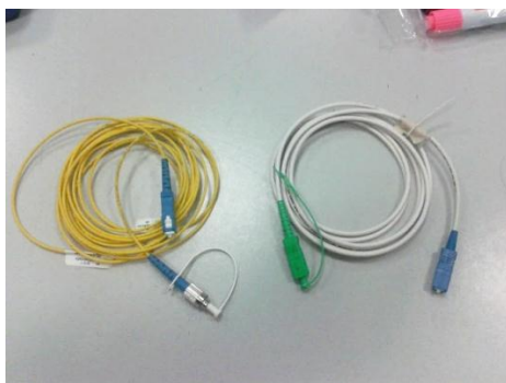
Figura 1.65. Tipos de conectores FC y SC.
