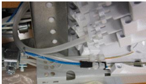
Figura 3.51. Orientación para cada tubo de transporte en las charolas.
