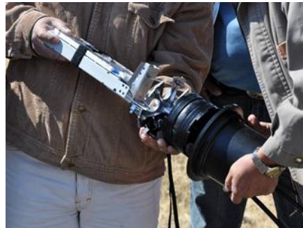
Figura 3.57. Alineamiento de la base con empaque
