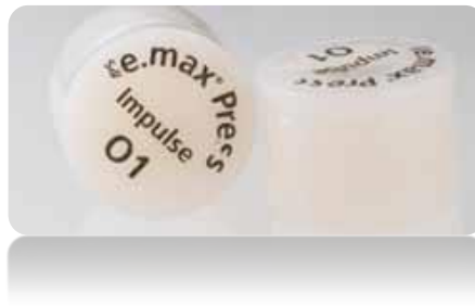
Figura 9 Pastillas IPS e. mx Press® compuestas de disilicato de litio.
