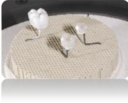
Figura 39 Piezas cerámicas colocadas sobre un panal para su cocción.
