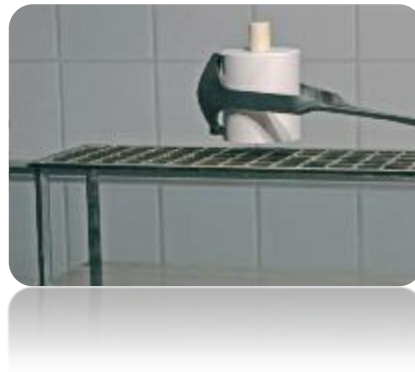
Figura 31 Enfriado del cilindro a temperatura ambiente
