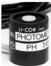
Imagen 3. Fotómetro. Sensor utilizado para mediciones de luz natural, unidad de medida: lux.
