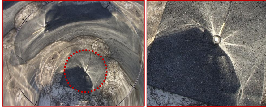
Imagen 1. Concentración de rayo solar sobre sensor
