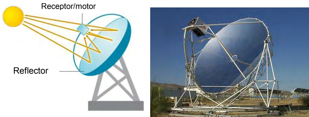
Figura 24 Concentrador solar de disco parabólico. Izq. Componentes. Der. Prototipo. 47
