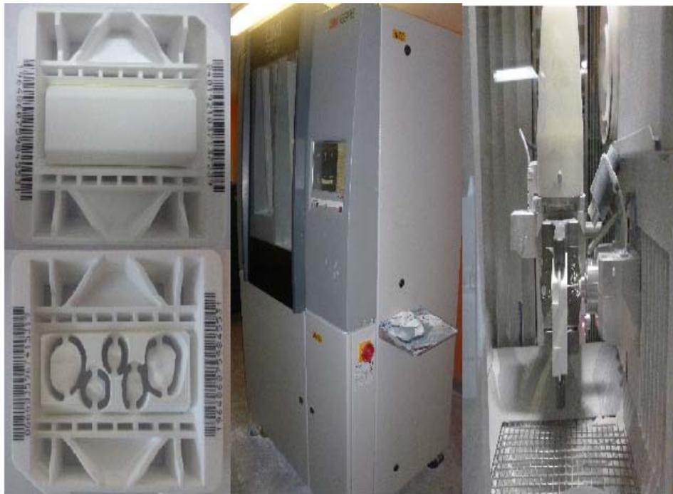
Figura 10 a) Bloque de ZrO<sub>2</sub> codificado b) Fresadora Lava® CNC500 c) Fresado de la estructura d) Estructura fresada en el bloque de ZrO<sub>2</sub>
