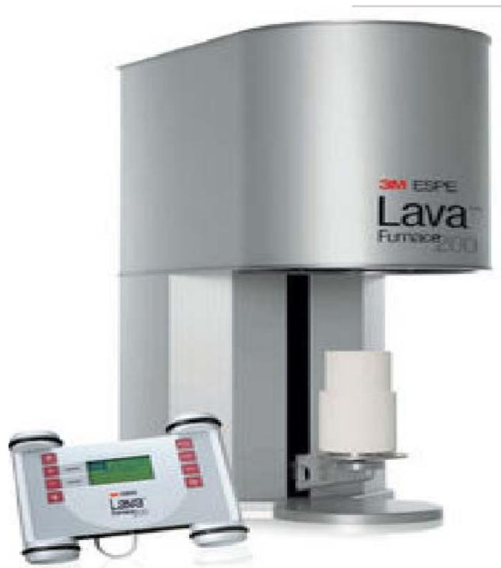
Figura 12 Horno de Sinterizado.
