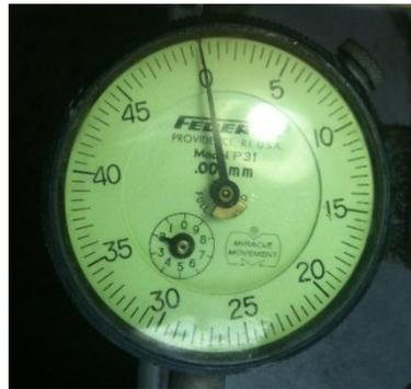
Fig. 16. Micrómetro de Reloj.
