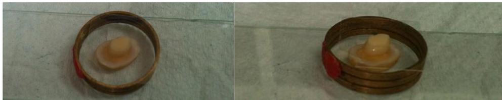
Fig. 20. Resina colocada en los especímenes.
