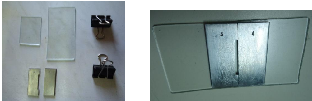
Figura 2. Plantilla de acero inoxidable, loseta de vidrio y sujetadores de mariposa
