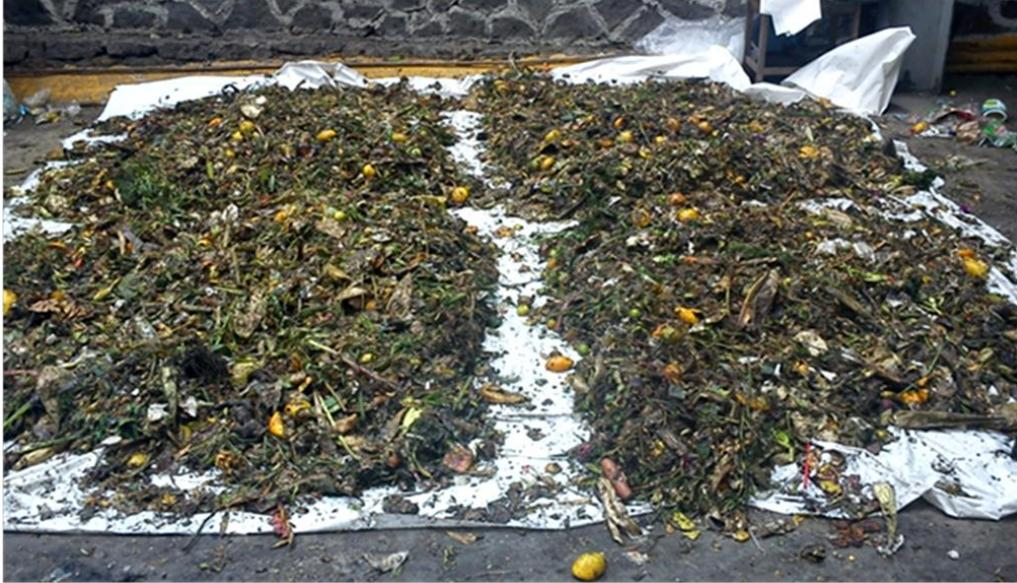
*Figura 4.1 Montículo de residuos dividido en cuatro partes conforme al método del cuarteo*
