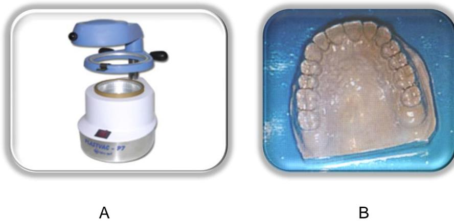
Fig. 48 A) Plastificador al vacio. B) Matriz plastificada sin recortar.
