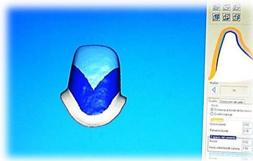
Figura A) Espacio para el Cemento en el Diseño del Núcleo de Zirconia.
