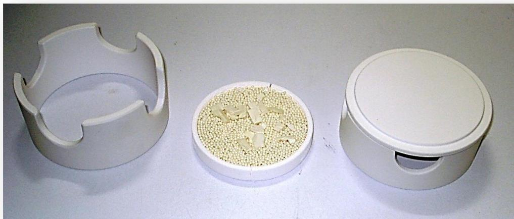
Figura B) Crisoles para el Horno Furnace® 200
