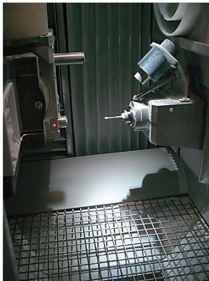
Figura B) Cabeza Fresadora del Sistema
