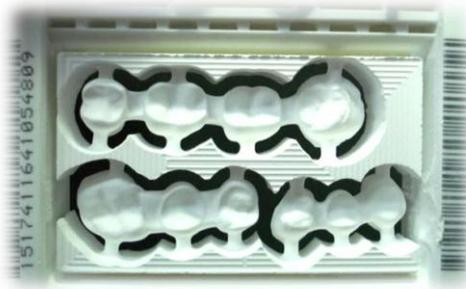
Figura A) Conectores de Prótesis de 3 y 4 Unidades Posteriores en Zirconia
