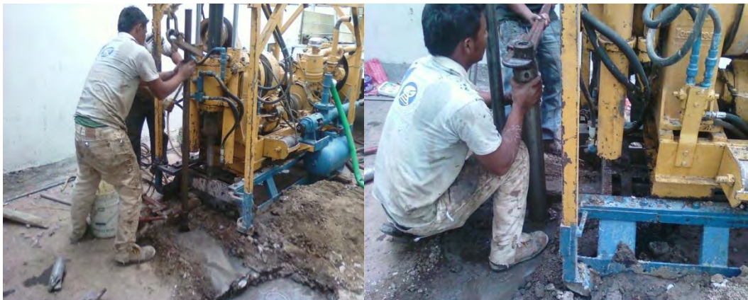
FIGURA: 11.- PRUEBA DE PENETRACION ESTANDAR
