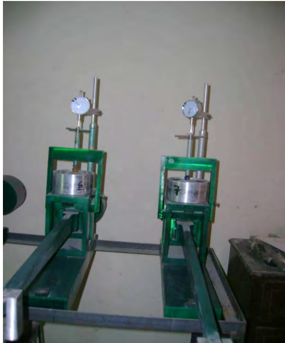
FIGURA: 18.- PRUEBA DE CONSOLIDACIÓN
