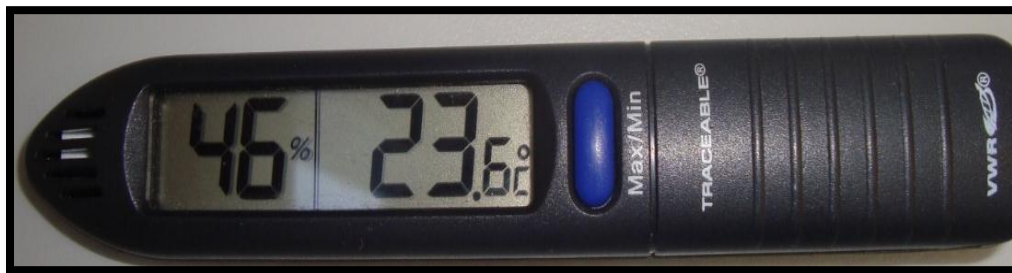
Fig. 3 Traceable R . Dispositivo para medir humedad y temperatura.
