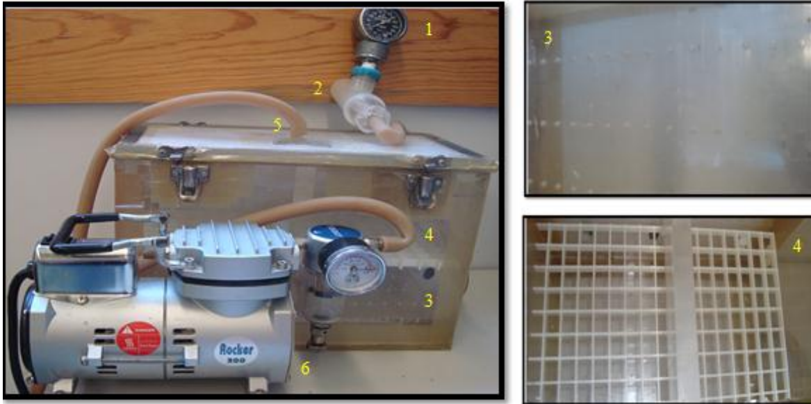
Fig. 2. Secador PPG con bomba de vacío. Donde, 1: Manómetro para controlar el flujo de aire. 2: Entrada del flujo de aire estéril y seco, 3: Salida del flujo de aire por 12 orificios de 2 mm de diámetro. 4: Soporte para el secado del papel filtro. 5: Sistema cerrado para generar vacío. 6: Bomba de vacío con manómetro para controlar la presión.
