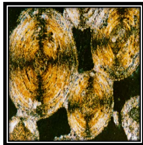
Fig. 2.8 Microfotografía Ooides modernos aragoníticos cuyo rango de tamaño de 0,1 a 1 mm, del Pleistoceno en Dunas, Bahamas (Mackenzie, 1997).
