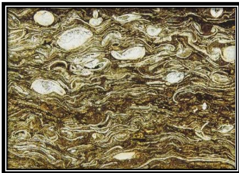
Fig. 2.33 Microfotografía que muestra una caliza con compactación de foraminíferos y ostrácodos, es una caliza del Carbonífero Inferior de Inglaterra (Tomada de Mackenzie, 1997).
