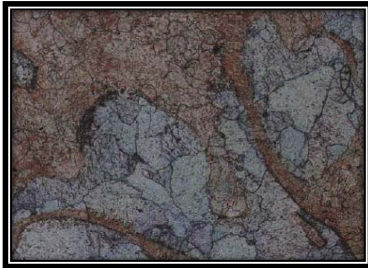
Fig. 2.29 Microfotografía en la cual se puede observar la textura cristalina de una caliza de Marruecos del Jurásico superior (Mackenzie, 1997).
