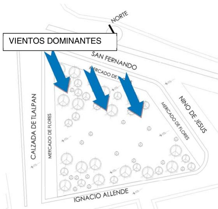
La ventilación puede generarse por medios naturales o mecánicos, o una combinación de estas dos. La ventilación natural es inducida por el viento debido a diferencia de temperatura entre el aire interior y el exterior, para facilitar la ventilación cruzada deberá disponerse las entradas de aire en las caras opuestas del edificio y sin grandes obstáculos que impidan el flujo del aire. Plantas poco profundas para facilitar la ventilación.
