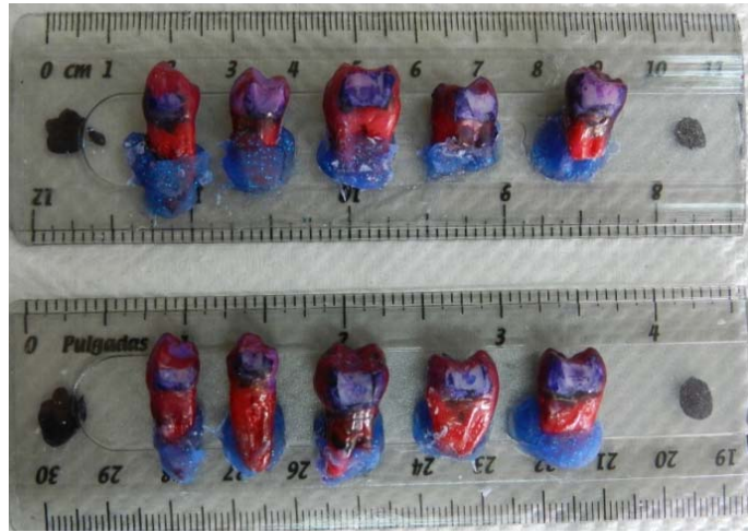
Fig. 20 Dientes montados en las reglas después de pasar 24 horas sumergidos en azul de metileno
