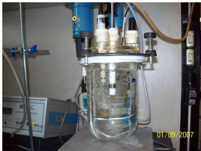
Figura B. 1 Celda de vidrio utilizada para la formación de la película de \text{FeCO}_3 .
