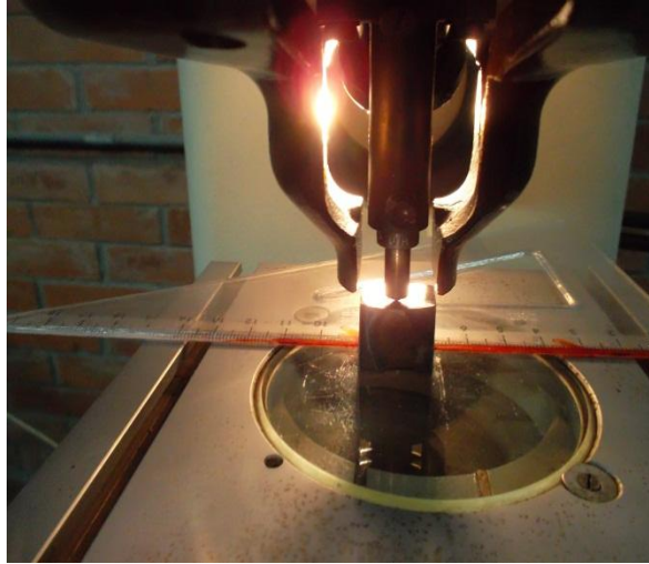
Fig. 3.9 Durómetro realizando una impronta en la muestra.
