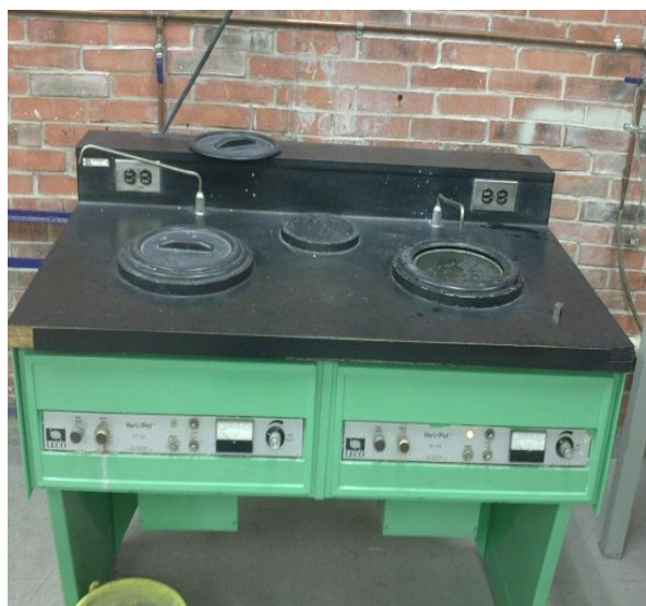
Fig. 3.2 Pulidora marca LECO, capacidad de 1000rpm
