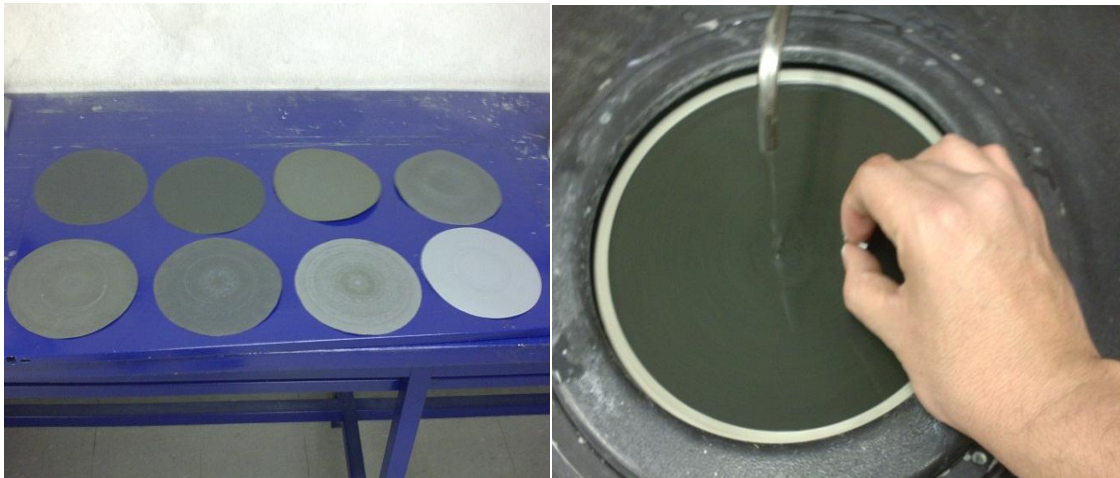
Fig. 3.4 Lijas Fandeli de 15cm de diámetro y desbaste de la probeta de acero.
