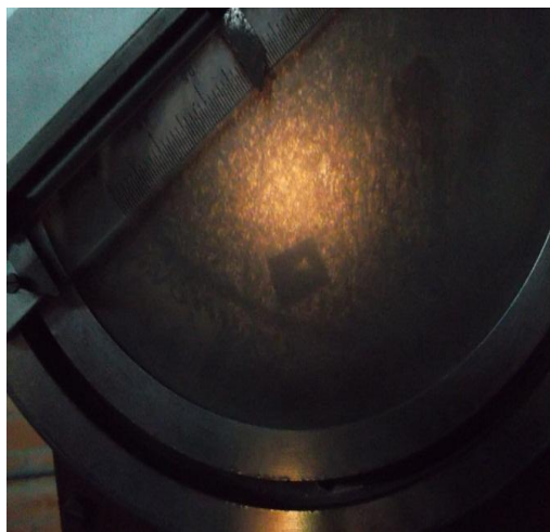
Fig. 3.11 Medición de la marca dejada por un indentador de diamante de pirámide con diagonales bien definidas en el durómetro AMSLER.
