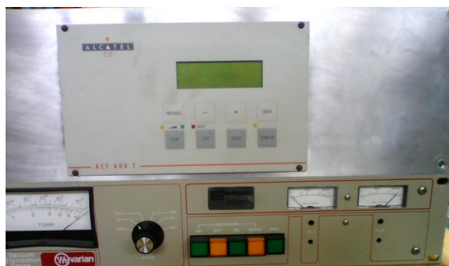
Figura 34. Izquierda detector de vacío ion-gate. Derecha controladores en la parte de arriba de la bomba turbo-molecular y en la parte de abajo de los detectores de vacío.
