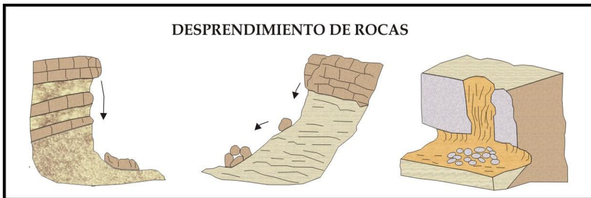
Figura 21. Se muestran distintos tipos de caídas, hay que mencionar que la inclinación de la ladera condiciona que el material rebote, ruede o se deslice (Servicio Geológico Metropolitano, 2005).
