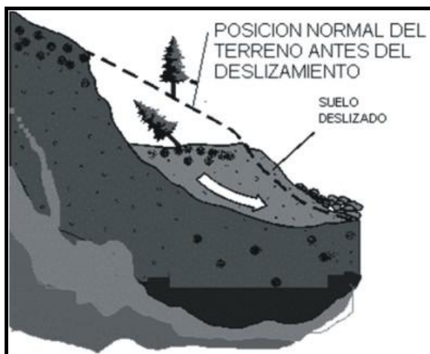
Figura 23. El diagrama muestra la superficie de rotura y el movimiento de la masa deslizante (Almaguer y Guardado, 2006).
