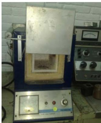
Fig. 3.6 Horno utilizado para tratamientos térmico (IIM-UNAM)
