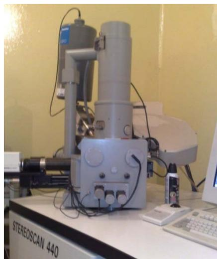
Fig. 3.15 Microscopio electrónico de barrido Stereoscan 440 (IIM-UNAM)
