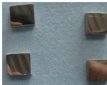
Fig. 3.12 Probetas de fundición y homogeneización
