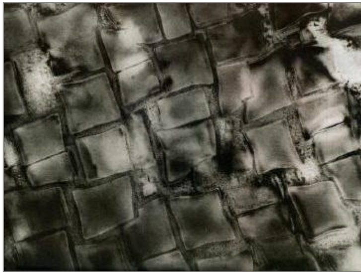
Figura 2.2. Microestructura de la fase gamma prima ( \gamma' ) incrustada en una matriz de fase gamma ( \gamma ).
