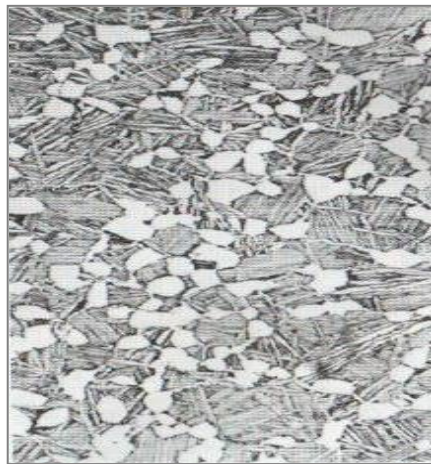
Figura 4.10. Muestra de una superaleación de titanio con cristales de fase \alpha de ambas formas.
