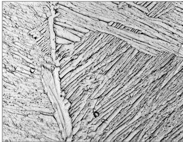
Figura 4.6. Microestructura laminar de una superaleación de titanio (enfriado lentamente desde la región de fase \beta ).
