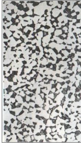
Figura 4.9. Forma esférica de los cristales de fase \alpha de las superaleaciones de titanio.
