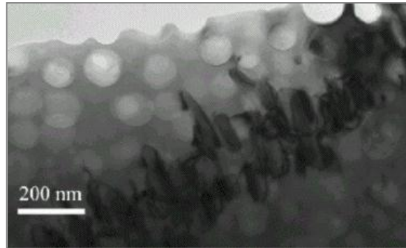
Figura 2.8. Microscopía electrónica de barrido que muestra una pequeña fracción de partículas \gamma' esférica en una matriz \gamma . Ni-20Cr-2.3Al-2.1Ti-5Fe-0.07C-B-0.005W en %. También ilustra en diagonal M_{23}C_6 partículas de carburo en el límite de grano.
