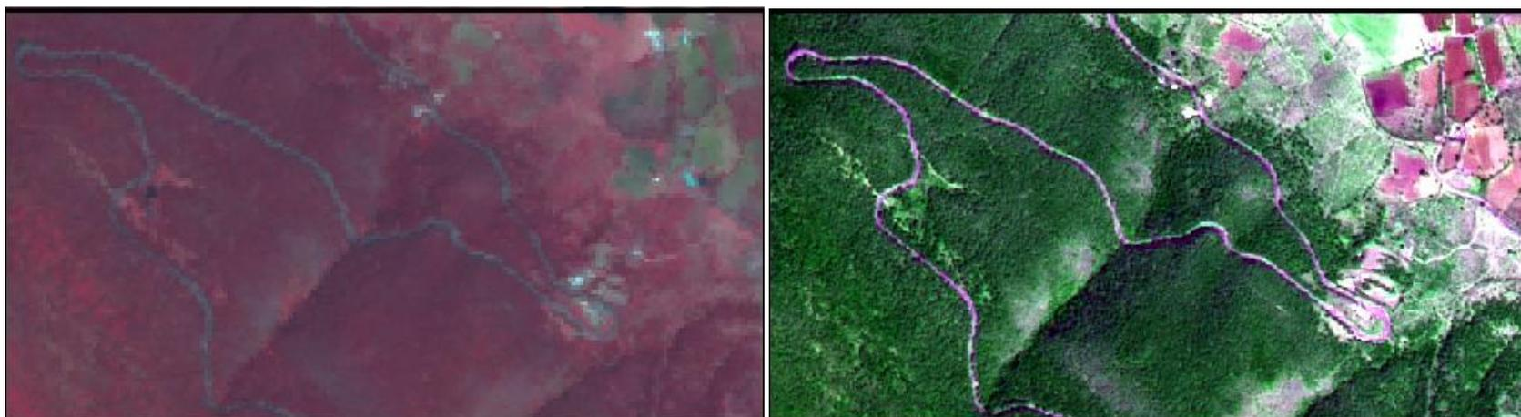
**Figura 19.** Izquierda, imagen multi-espectral 10 m/pixel, derivada del compuesto RGB 123; Derecha multi-espectral fusionada 2.5 m/pixel, derivada del compuesto RGB 213 (Caso de estudio 1 en Figura 21)
