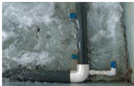
Figura 4.14 Dispositivos para producir turbulencia en la tina
