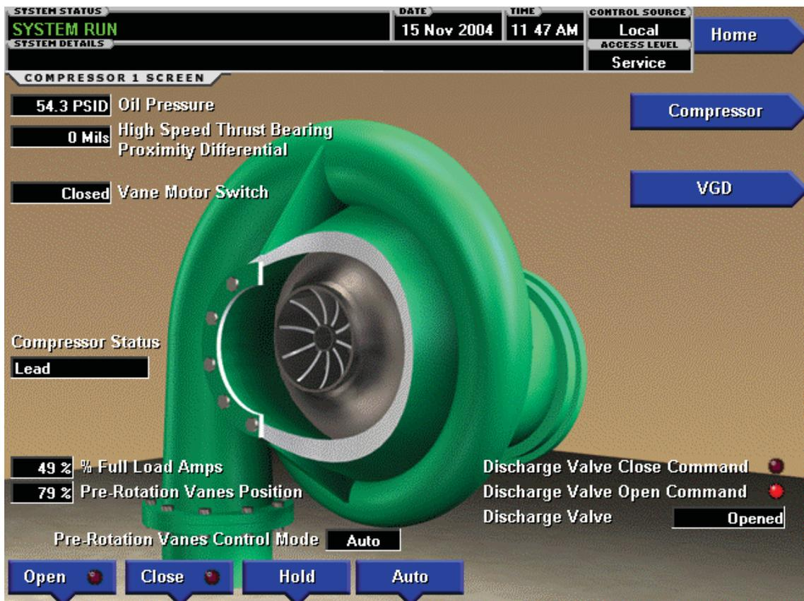
Figura 2.5 Pantalla de un compresor (Extraído de Control center centrífugal liquid chillers, form 160.69.01, 108, York, pag 38)
