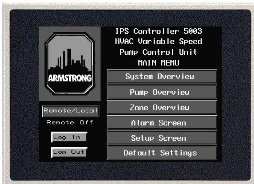
Figura 4.21 Menú principal del controlador de velocidad variable IPS 5000 Extraído de Sistemas de bombas integradas, controlador IPS 5000, archivo No. 90.81 SP, Armstrong, pag. 110)
