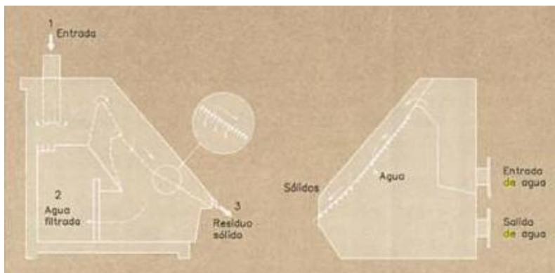
Figura 2.10: Reja autolimpiante. Los sólidos se deslizan por encima de la rejilla con una inclinación suficiente para autodescargarse en la parte inferior mientras el agua atraviesa la rejilla.
