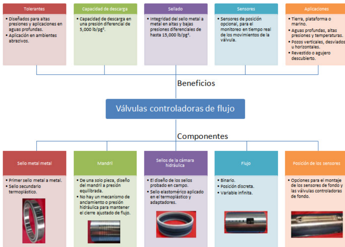
Figura 3.9 Componentes y beneficios de las VCF 14 .
