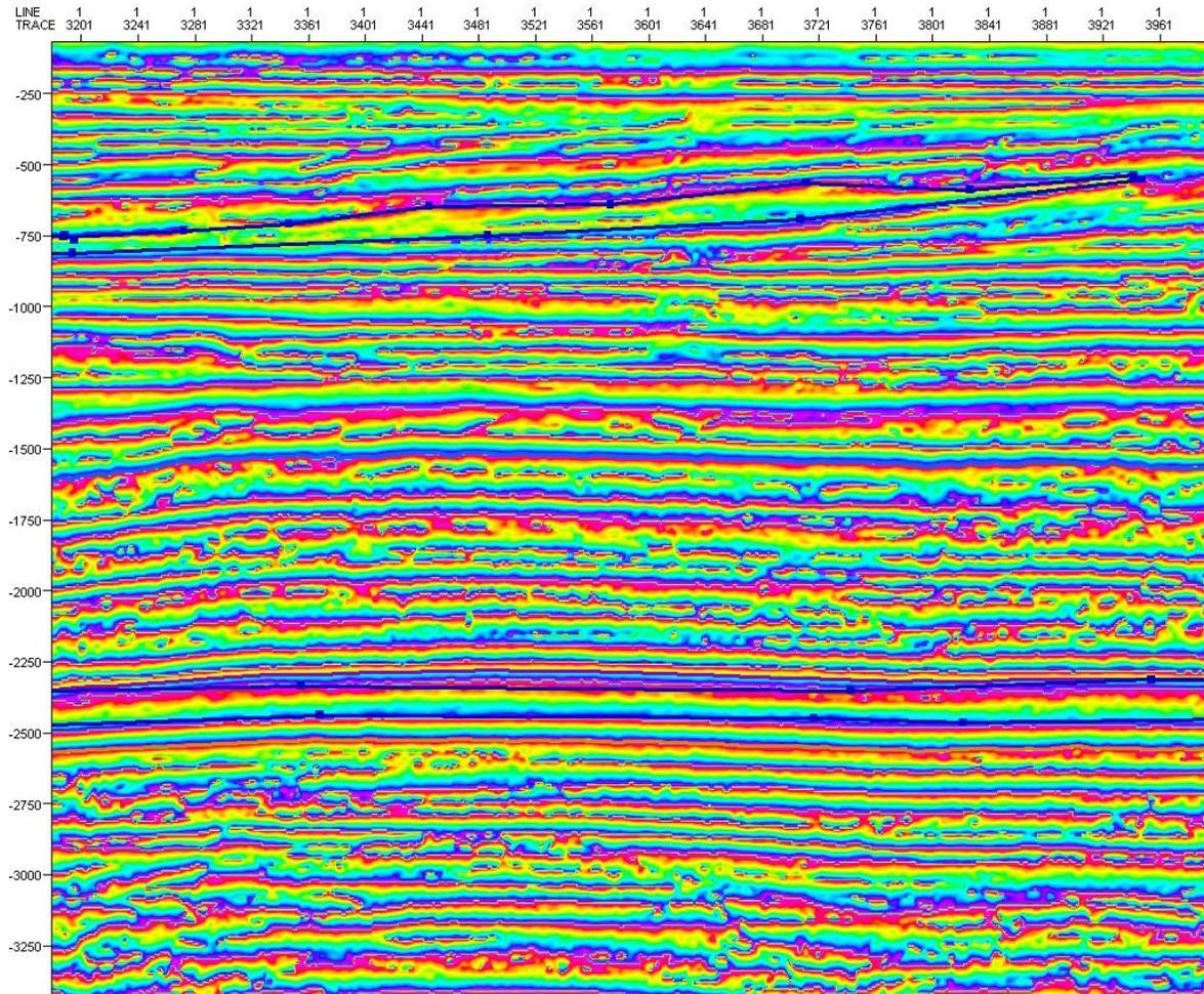
Fig. 5.15 Sección Sísmica Chicx C. Continuidad lateral de los estratos.
