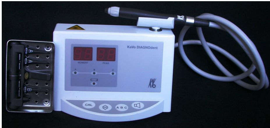
Foto 5. Dispositivo de fluorescencia láser DIAGNOdent de la casa comercial Kavo
