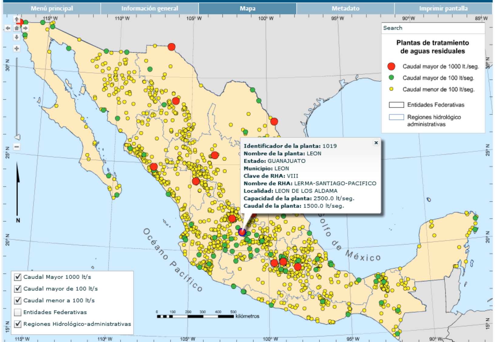
Mapa que presenta la localización de las plantas de tratamiento de aguas residuales municipales clasificadas por caudal tratado.
