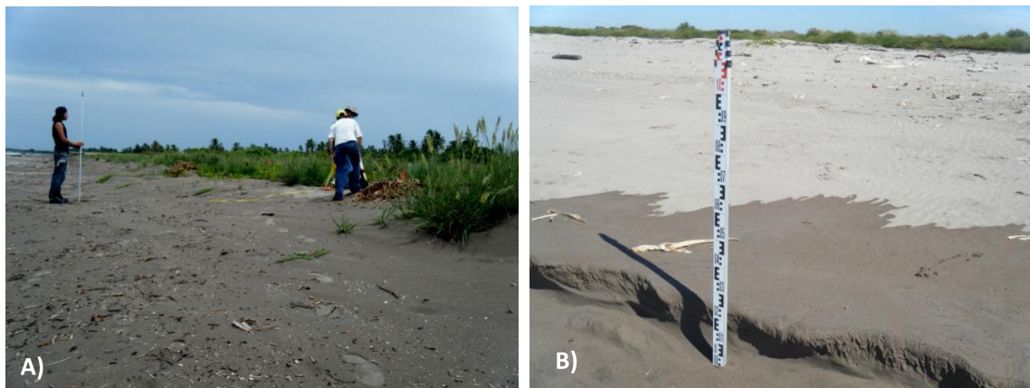
Figura 3.1 Localización y ajuste del nivel automático en los sitios seleccionados. A) Línea de vegetación en el perfil 17 Playa El Borrego, es el criterio utilizado para todas las estaciones como punto de referencia y de inicio. B) Lectura de un punto en el perfil de playa 15 Playa del Rey, dicho punto corresponde al escalón de berma, un indicador heurístico de la posición de la línea de costa.
