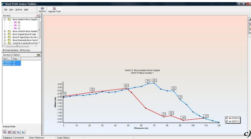
Figura 3.3 Representación y análisis de los perfiles de playa con BPAT. a) La información recopilada en los formatos de trabajo en campo fue capturada en este software con la opción “Survey Data Editor”; b) Pantalla para capturar los códigos de los rasgos geomórficos u otros indicadores de la posición de la línea de costa registrados durante la salida a campo; c) Se utilizó el módulo Analysis Tools para comparar el cambio en la posición de los diferentes indicadores, además esta herramienta permite apreciar cualitativamente las variaciones en la morfología del perfil en función de varios criterios como la zona del perfil de playa; d) Representación gráfica de los valores de la tasa de sedimentación expresada en m^3/m de acuerdo al análisis por segmentos en dirección horizontal del perfil de playa.
