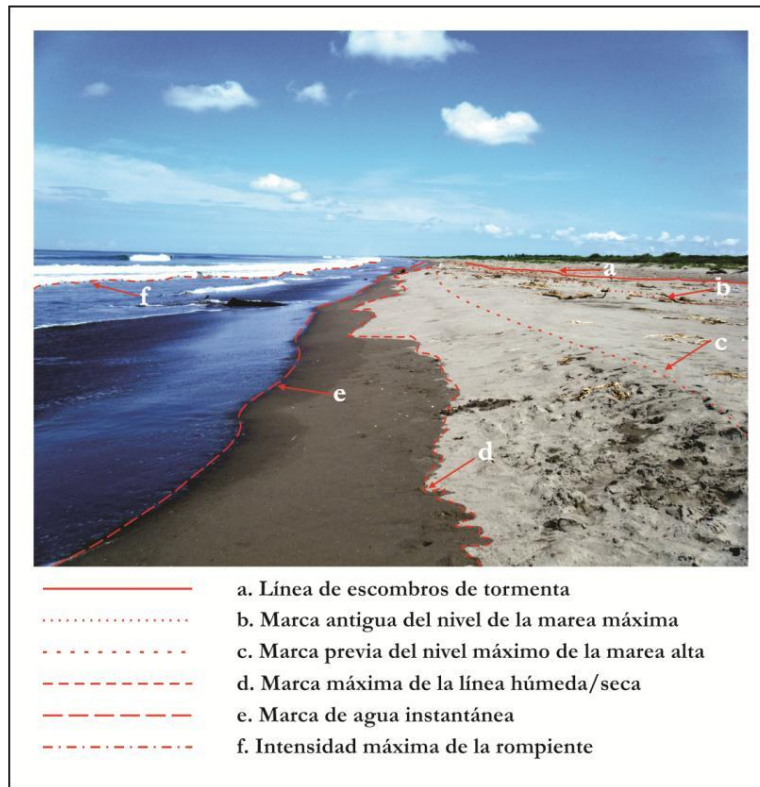
Figura 1.5 Marcas de agua más comunes de identificar directamente en campo. En algunos lugares como Playa del Rey, se pueden identificar hasta seis marcas de agua; aunque varían en rangos de tiempo de microescala, se asumen como promedio de la posición relativa de la línea de costa.
