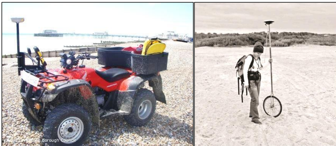
Figura 1.2 A) Vehículo adaptado con dos antenas GPS para recepción de señal de alta frecuencia, registra la línea de costa en sectores relativamente rectos de la playa. B) Antena GPS adaptada a monociclo y controlada por el operador, es útil para delinear la línea de costa en sectores de relieve o topografía “accidentados” o modificados por el hombre. (Baptista et al. , 2011).
