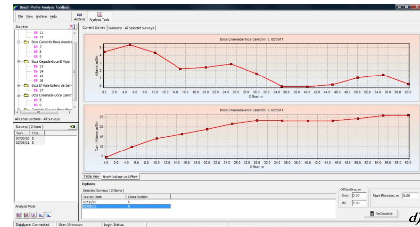
Figura 3.3 Representación y análisis de los perfiles de playa con BPAT. a) La información recopilada en los formatos de trabajo en campo fue capturada en este software con la opción “Survey Data Editor”; b) Pantalla para capturar los códigos de los rasgos geomórficos u otros indicadores de la posición de la línea de costa registrados durante la salida a campo; c) Se utilizó el módulo Analysis Tools para comparar el cambio en la posición de los diferentes indicadores, además esta herramienta permite apreciar cualitativamente las variaciones en la morfología del perfil en función de varios criterios como la zona del perfil de playa; d) Representación gráfica de los valores de la tasa de sedimentación expresada en m^3/m de acuerdo al análisis por segmentos en dirección horizontal del perfil de playa.
