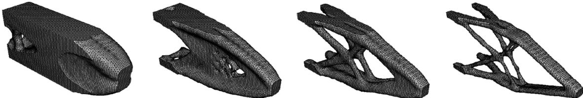
Fig. 1.7. Ejemplo de una estructura óptima obtenida mediante ESO [26].
