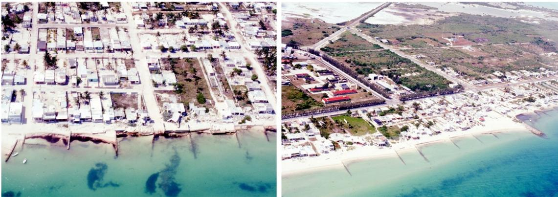
Figura 1-3 Fotografías aéreas que muestran las múltiples estructuras (escolleras y espigones) construidas por lo residentes de la costa para proteger sus propiedades de la erosión. Fuente: Meyer-Arendt(1994).
