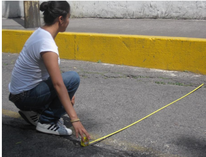
Figura 1.8 Medición de la distancia entre fracturas.
