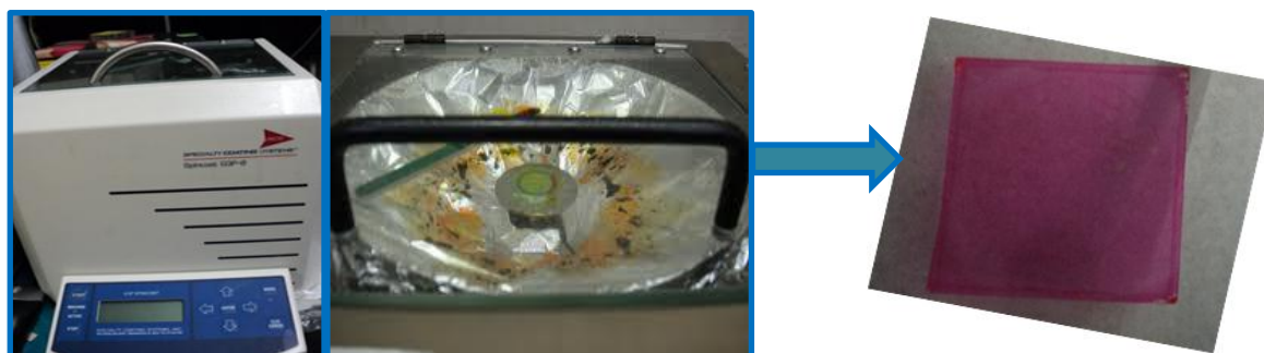
Figura 2.1 Se observa el Spinner SCS G6P-8 y la base de centrifugado (izquierda), y se observa una película depositada (derecha).
