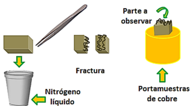
Figura 3.6: Representación de la preparación de las muestras para la observación en forma trasversal
