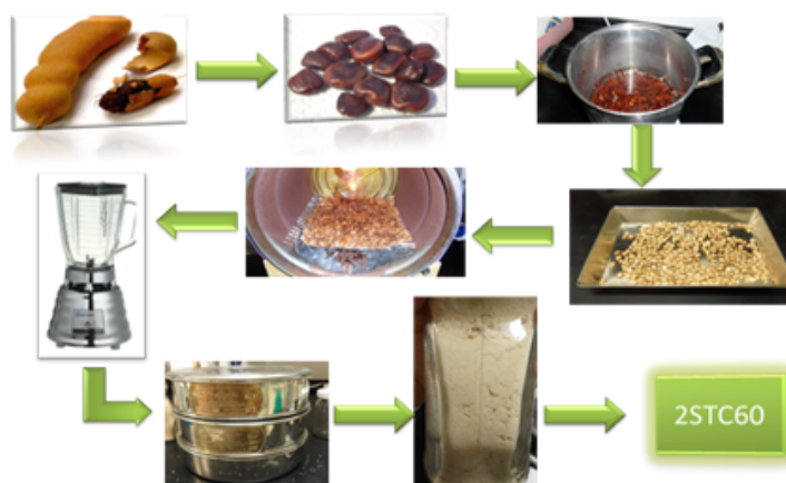
Figura 3.2: Proceso de obtención del polvo de la semilla de tamarindo
