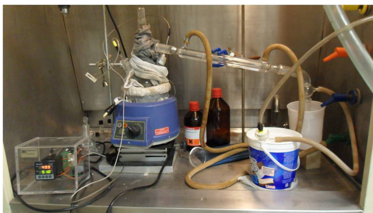
Figura 3.1: Proceso de eliminación del inhibidor del monómero
