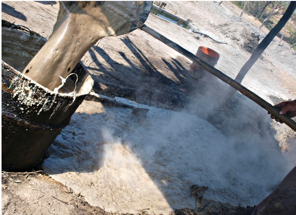
Figura 24. Vaciado de la espumadora en un tambo con válvula
