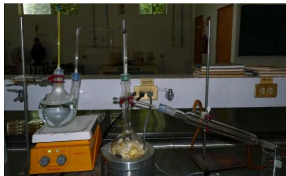
Figura 4.24. Montaje de arrastre de vapor
