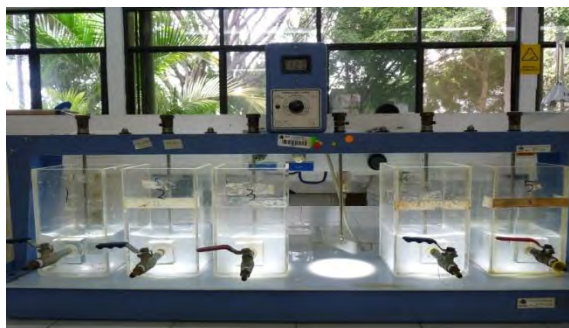
Figura 4.33. Equipo de Jarras Phipps & and Bird para realizar pruebas en Batch
