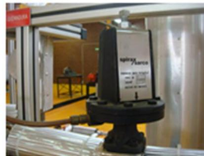
Fig. 26.- Válvula de control auto accionada
