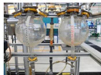
Fig. 59.- Tanques para concentrado y condensado
