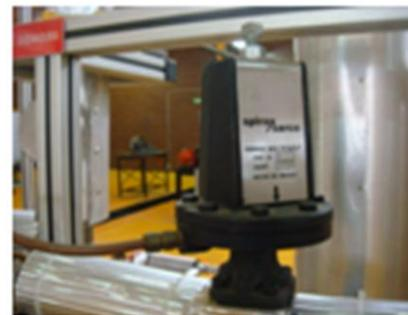
Fig. 49.- Válvula de control autoaccionada
