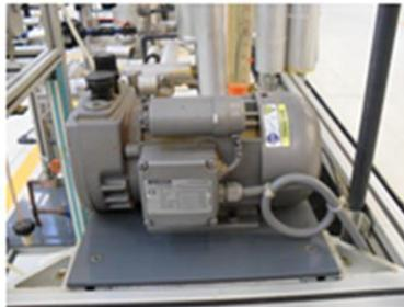
Fig. 38.- Bomba de vacío
