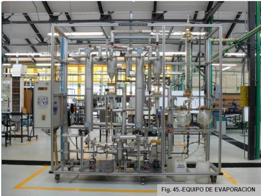
Fig. 45.-EQUIPO DE EVAPORACIÓN
