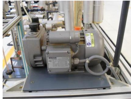
**Fig.-2.8 Bomba de Vacío**
