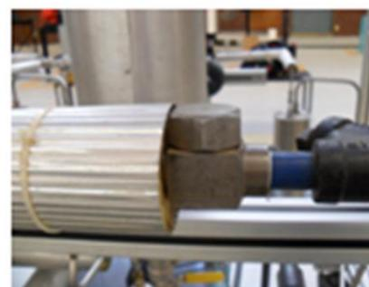
Fig. 51.- Trampa termodinámica
