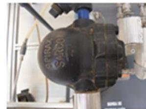
**Fig. 29.- Trampa tipo flotador**
