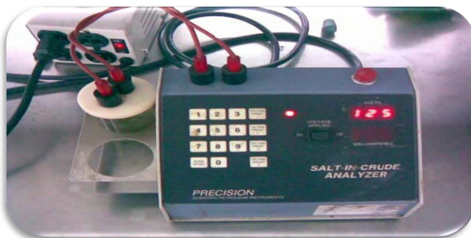
Figura 1-1 Analizador convencional de sal contenida en el crudo.
