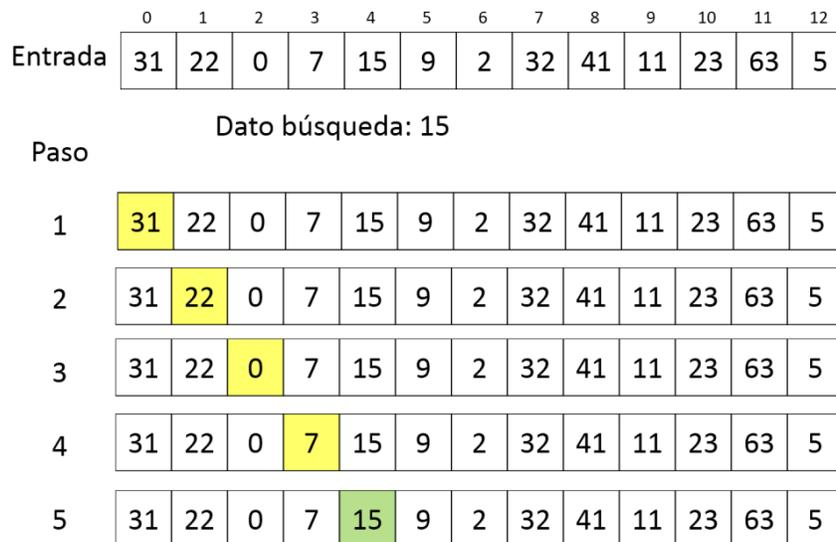
Figura 12 Visualización de una búsqueda lineal.
